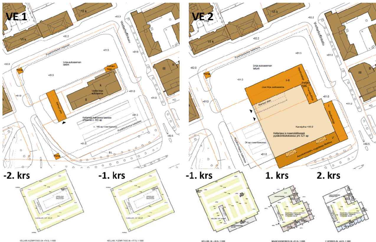
Kuva 12. Linja-autoaseman vaihtoehdon alustavat tilavaraukset, VE1 ja VE2.
