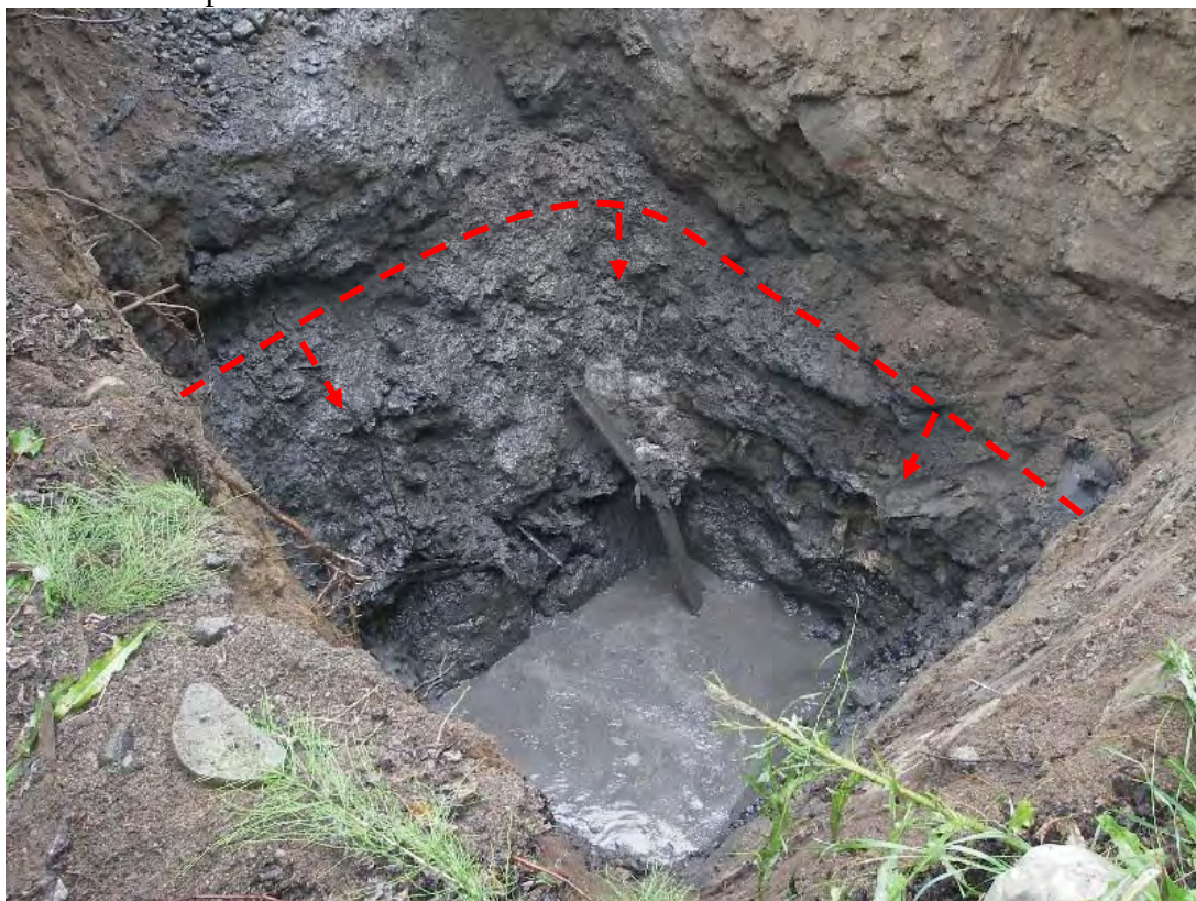
Kuva 2. Koekuopan KK43 alueella todettu, jätetäytön sekainen maa-ainekkerros, jossa todettiin alemman ohjearvon ylittävä sinkki- ja ylemmän ohjearvon ylittävä kuparipitoisuus
