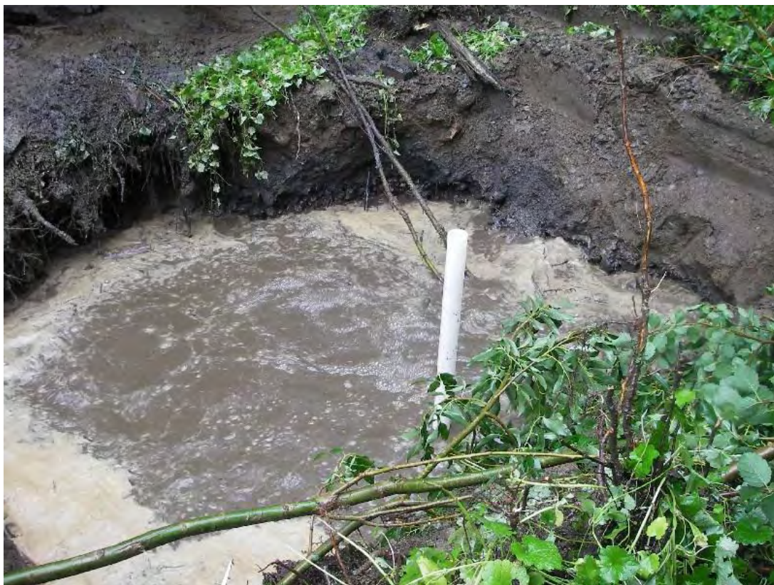
Kuva 1. Koekuoppaan KK35 suotautunut orsivesi ja veden laadun selvittämiseksi asennettu tarkkailuputki KK35/L1.
