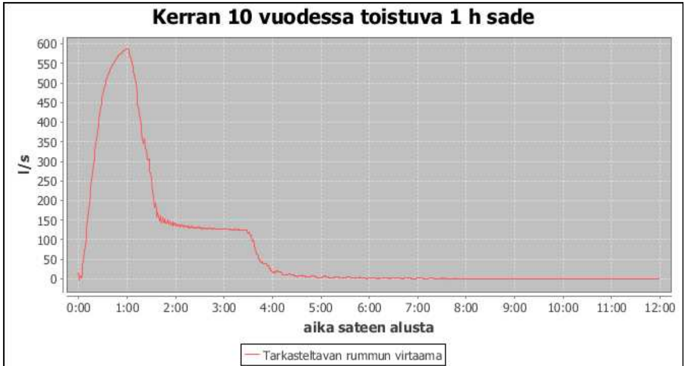
Kuva 3. Mallinnettu nykyinen virtaama moottoritien alittavassa Vanajaveteen laskevassa rummussa kerran 10 vuodessa toistuvassa 1 h sadetilanteessa, kun Vanajavesi on ylivedenkorkeudella N_{60}+80,0 m.
