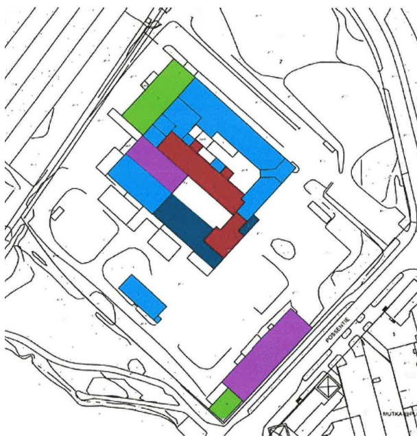
Kuva 21. Mensan kiinteistön pääasialliset rakennusvaiheet.
