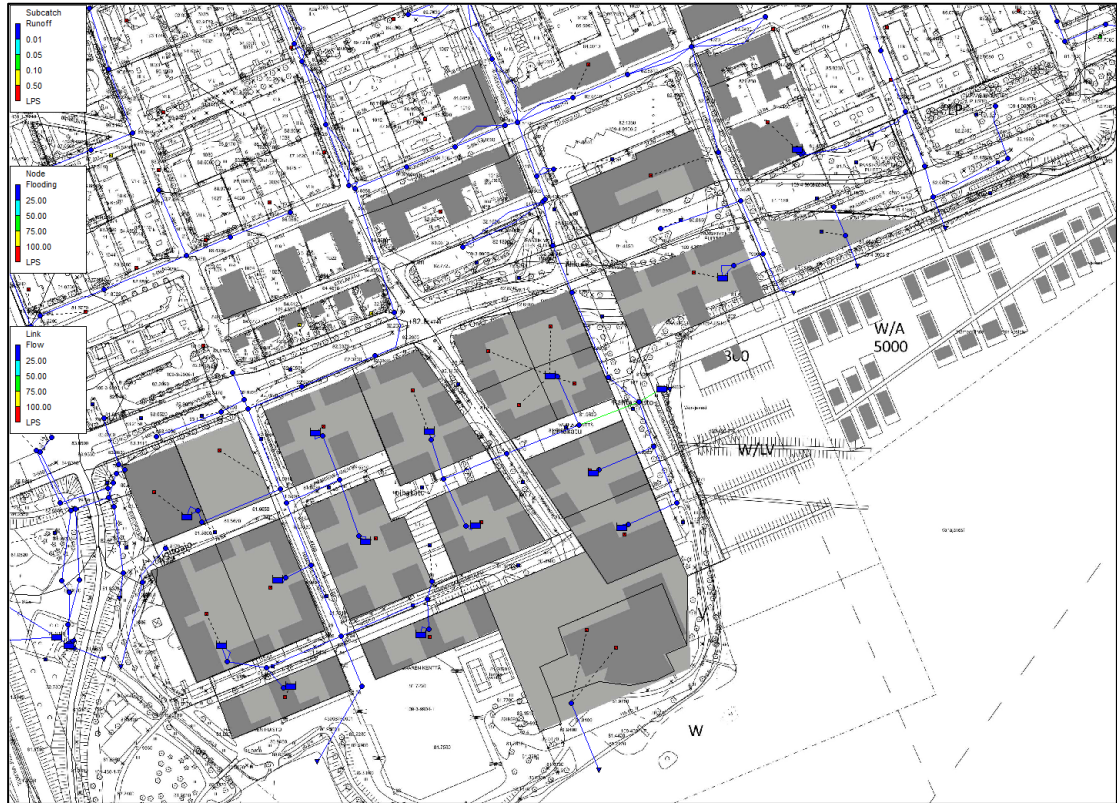
Kuva 5. Tulevan tilanteen SWMM-hulevesimalli.
