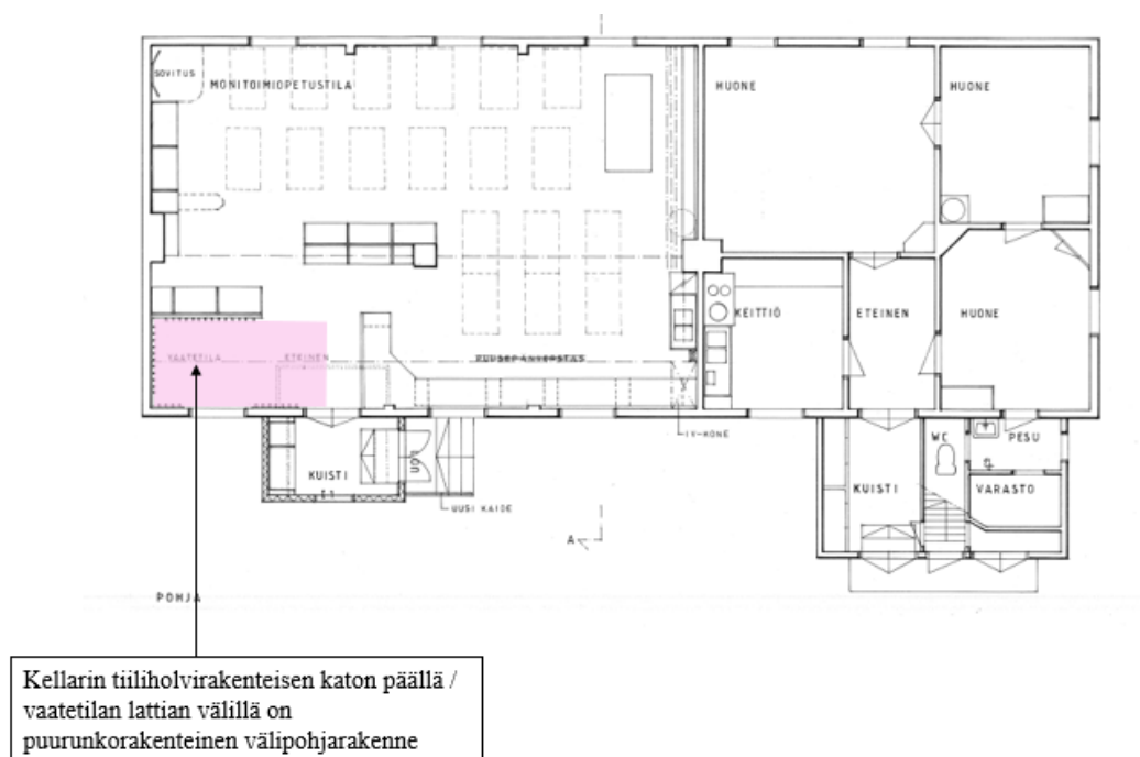
Kuva 20. Kellarin katon päällä on välipohjarakenne
