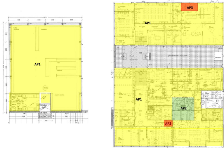
Kuva 2. Alapohjarakenteet ovat pääosin maanvaraisia.
