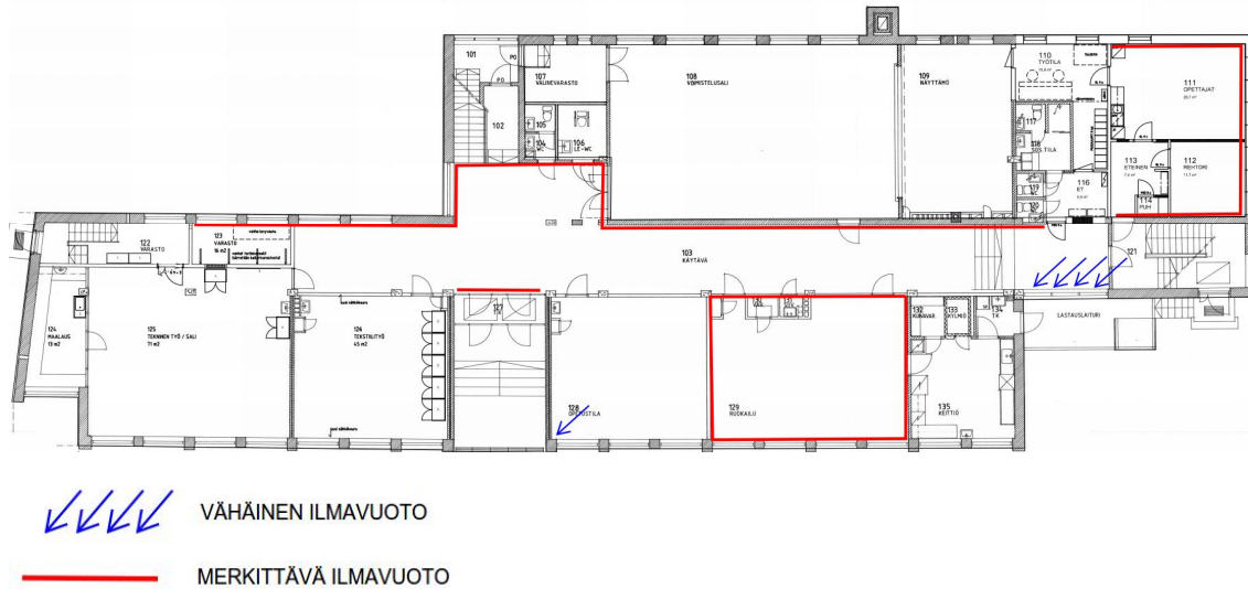
Kuva 27. Välipohjan ilmavuodot kerroksessa 1. Punainen viva: jatkuva ilmavuoto, Sininen nuoli, vähäinen ilmavuoto.
