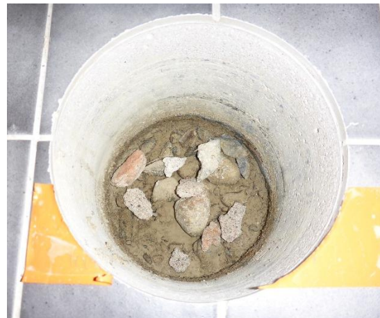
Kuva 5. Täyttömaa on kapillaarisesti vettä nostavaa seulomatonta hiekkaa.
