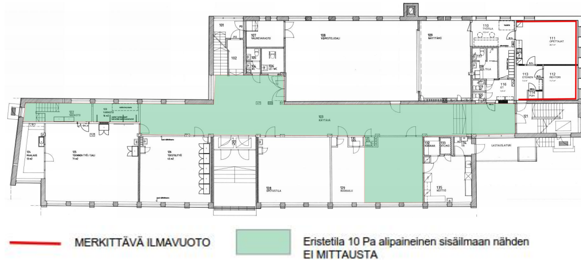
Kuva 26. Tavanoamisessa painesuhteessa havaitut välipohjavuodot kerroksessa 1. Vihreällä merkitty voimakkaasti alipaineinen eristetila.
