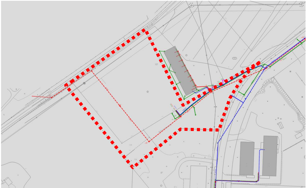
Puhtaan veden, jäteveden ja sadeveden putkistot suunnittelualueella.
