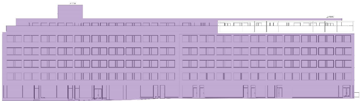
Kuva 49 Rakennuksen julkisivu luoteeseen eli Raatihuoneenkadun suuntaan on säilynyt pitkälti muuttumattomana. Alkuperäisenä säilyneet osat ovat merkitty julkisivuun violetilla.
