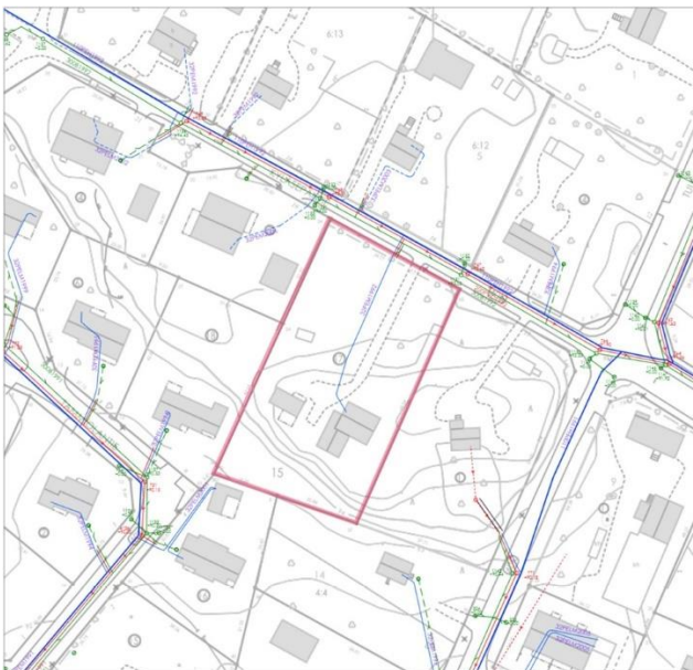
Kuva 7. Tonttivesijohdon sijainti keskellä tonttia.
