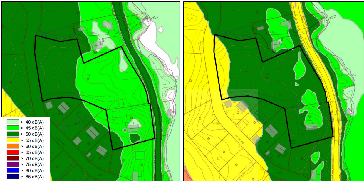
Kuva 12. Vasemmalla yöajan melukartta v. 2015 ja oikealla yöajan melukartta v. 2040. Suunnittelualueet on rajattu kuviin mustalla. (Promethor Oy, 2017)
