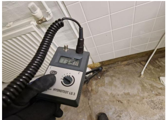
Kuva 19. Alapohjista mitattiin merkittäviä pintakosteuspoikkeamia.
