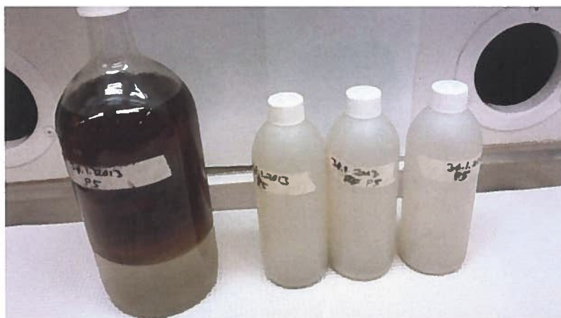
Kuva 1. Pohjavesiputkesta 5 otettu näyte, jossa pinnalla öljyä.
