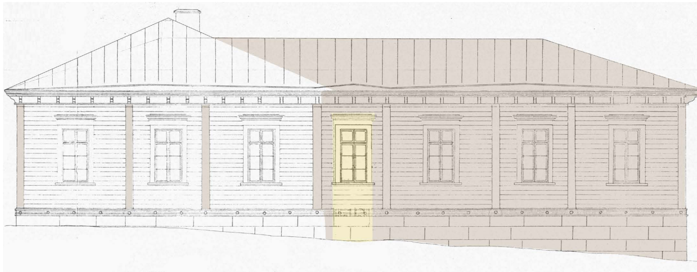
Uusin julkisivupiirros pohjoisjulkisivusta on 1930-luvulta. Sen pohjalta on laadittu ajoituskaavio, jossa näkyy merkittävimmät siihen tehdyt muutokset. Värittämätön osa julkisivusta on edelleen lähes alkuperäisessä asussaan. (Pohjakuva: rouvasseuran talosta löytynyt kopio)
