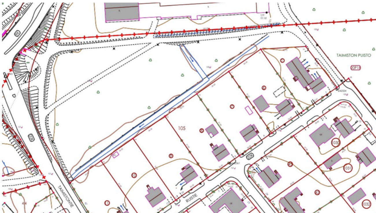
Kuva 6. Kaava-alueen rajalla kulkee koillis-lounaissuuntainen yhteisoja, joka päättyy Taimistontien hulevesiputkistoon ja sieltä suppaan.
