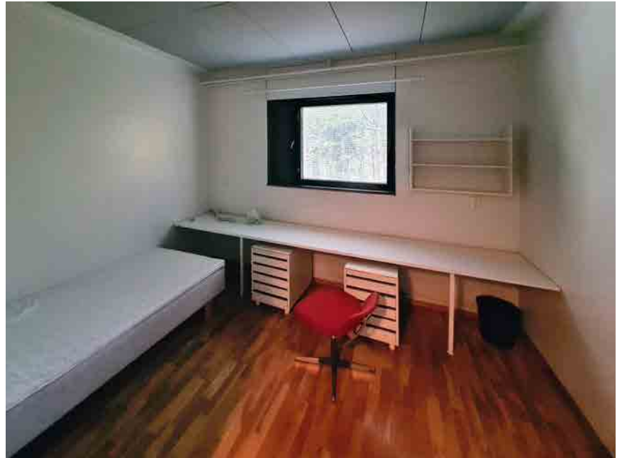
Kuva 259: Kuva asuntolan asuinhuoneesta. 1970-luvun ikkunakoon merkitys välittyy tässä kuvassa muiden asuntolojen asuinhuonekuviin verrattuna selkeästi. Ne tuovat huomattavasti niukemmin luonnon valoa huoneisiin, mikä puolestaan lisää huoneen sähkövalaisinten käytön tarvetta.
