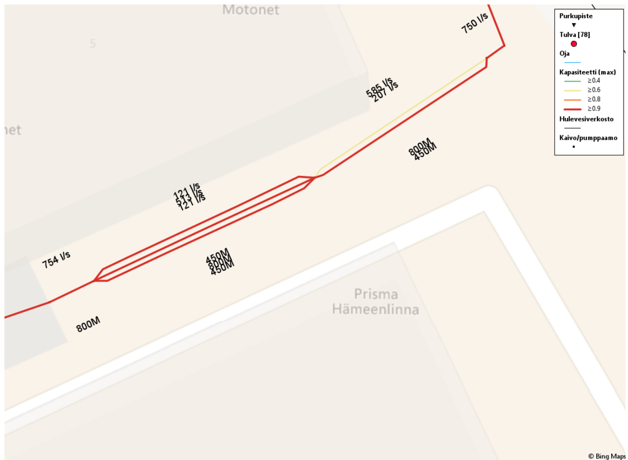
Kuva 19. Nykyisen viivytyksen kapasiteetti, putkikoot ja virtaamat.
