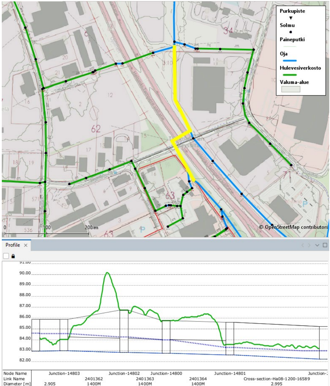
Kuva 17. Helsinki-Tampere valtatie alittavan rummun pituusleikkaus 1/100a.
