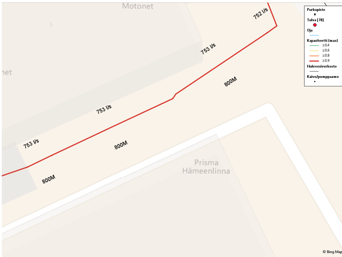
Kuva 20. Kuvitteellisen verkoston kapasiteetti, putkikoot ja virtaamat.
