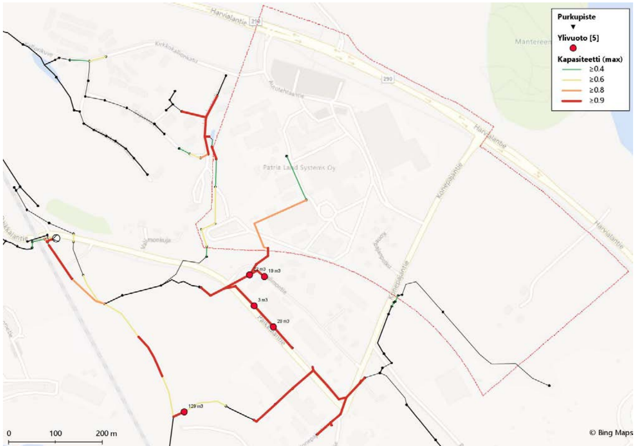
Kuva 13. Hulevesiviemärin ja ojien kapasiteetti mitoitussateella tulevassa tilassa.
